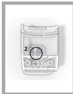
2. AVVITARE LA VITE PER EVITARE LA ROTAZIONE DELLA FOTOCELLULA. Screw in the screw to fix the photocell case.
