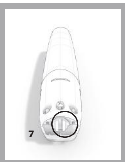
7. UTILIZZANDO UNA MONETA O UN CACCIAVITE ORIENTARE LO STAMPATO. +180° / - 180° di rotazione. Use a coin or a screwdriver to rotate the PCB and adjust +180° / - 180° rotation.
