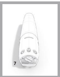
7. UTILIZZANDO UNA MONETA O UN CACCIAVITE ORIENTARE LO STAMPATO. +180° / - 180° di rotazione. Use a coin or a screwdriver to rotate the PCB and adjust the alignment between TX and RX. +180° / - 180° rotation.
